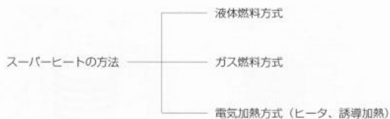
図7 スーパーヒートの方法
