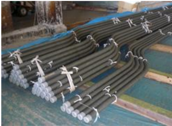
加熱炉管曲げ加工 (冷間曲げ)
