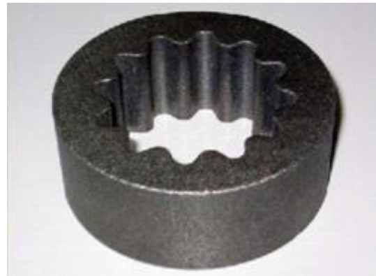
内面ヒレ管断面図
