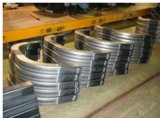
建設車両の窓枠用コラム曲げ管
