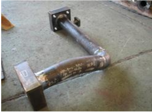
高周波曲げを使用した油圧配管
