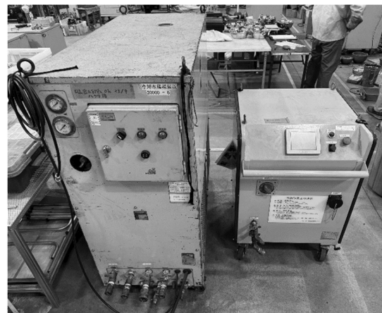
図1 高周波電源（右）と冷却水循環装置（左）
